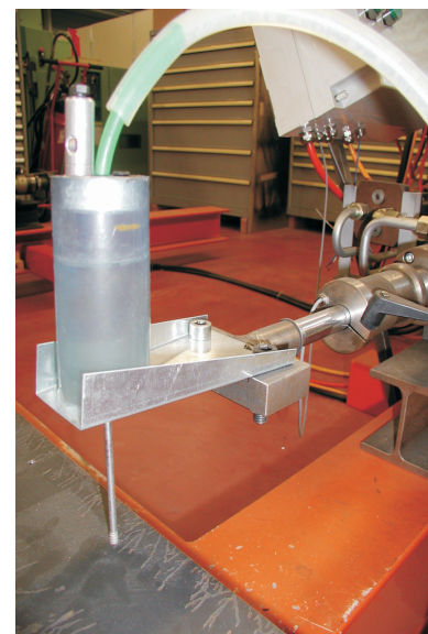
рис.1 Лабораторный тест на устойчивость самореза к раскачиванию и герметичности шайбы
